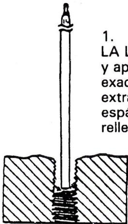
1. MANTENER CORTA LA LONGITUD DEL ARCO y aplicar sobre el centro exacto el electrodo de extracción de tornillos y espárragos rotos, rellenando el taladro.
